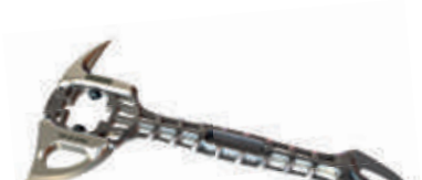
1130 247 Machadinha de resgate em titânio Crash Axe Paratech Machadinha de resgate robusta, versátil e leve. • Cabo de titânio a transforma em uma ferramenta superleve; • Gume e picareta substituíveis; • Lâmina de aço inoxidável; • Peso total de £ 2,5 / 1,13 kg; • Grande superfície de corte; • Integrado de corte de metal com Garra (abridor de lata) e corte de fios e arame; • Cabo com parafusos para a troca de novas lâminas, picaretas e mais.
